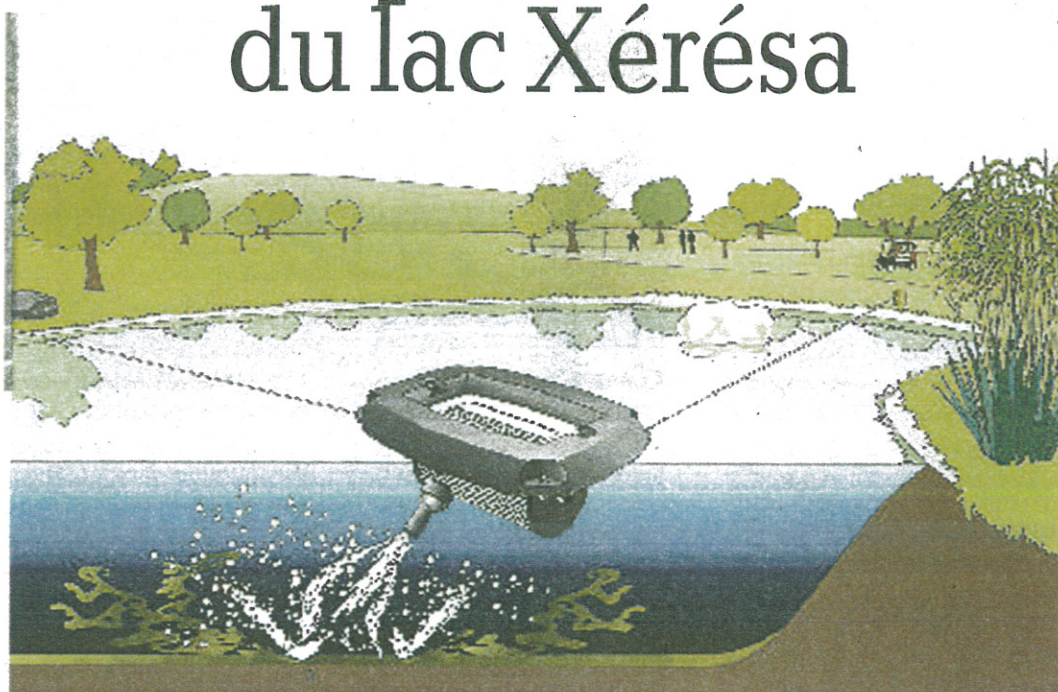
Exemple d'aérateur d'eau étudié pour améliorer la situation au lac de Xérés.
