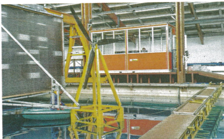
Brest (Finistère), le 16 septembre. Une maquette au cinquantième de l'éolienne qu'Eolink veut implanter en mer a subi l'effet du vent et des vagues dans un bassin.
