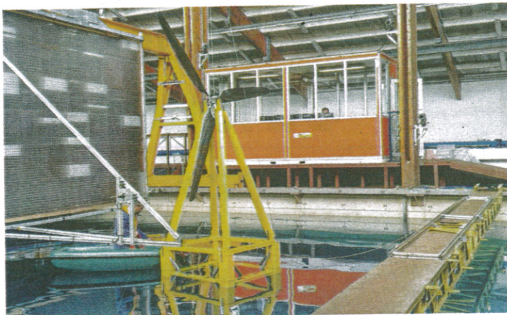
Brest (Finistère), le 16 septembre. Une maquette au cinquième de l'éolienne qu'Eolink veut implanter en mer a subi l'effet du vent et des vagues dans un bassin.
